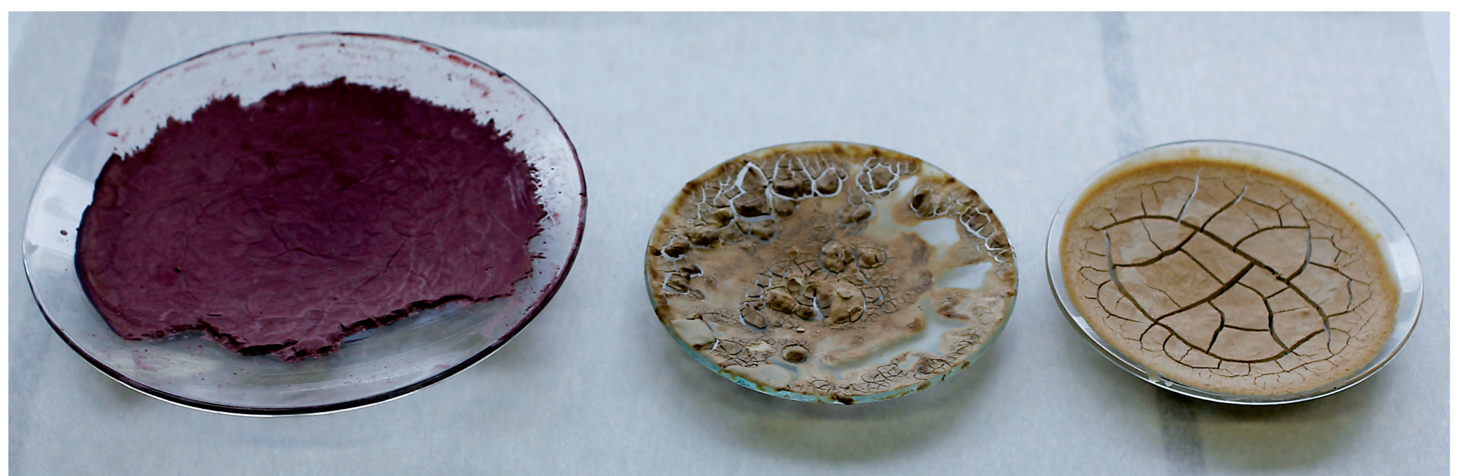
Abb. 1b Trocknung des Weintrubs (links Burgunder, rechts Riesling) in Wannen aus PE-Folie
