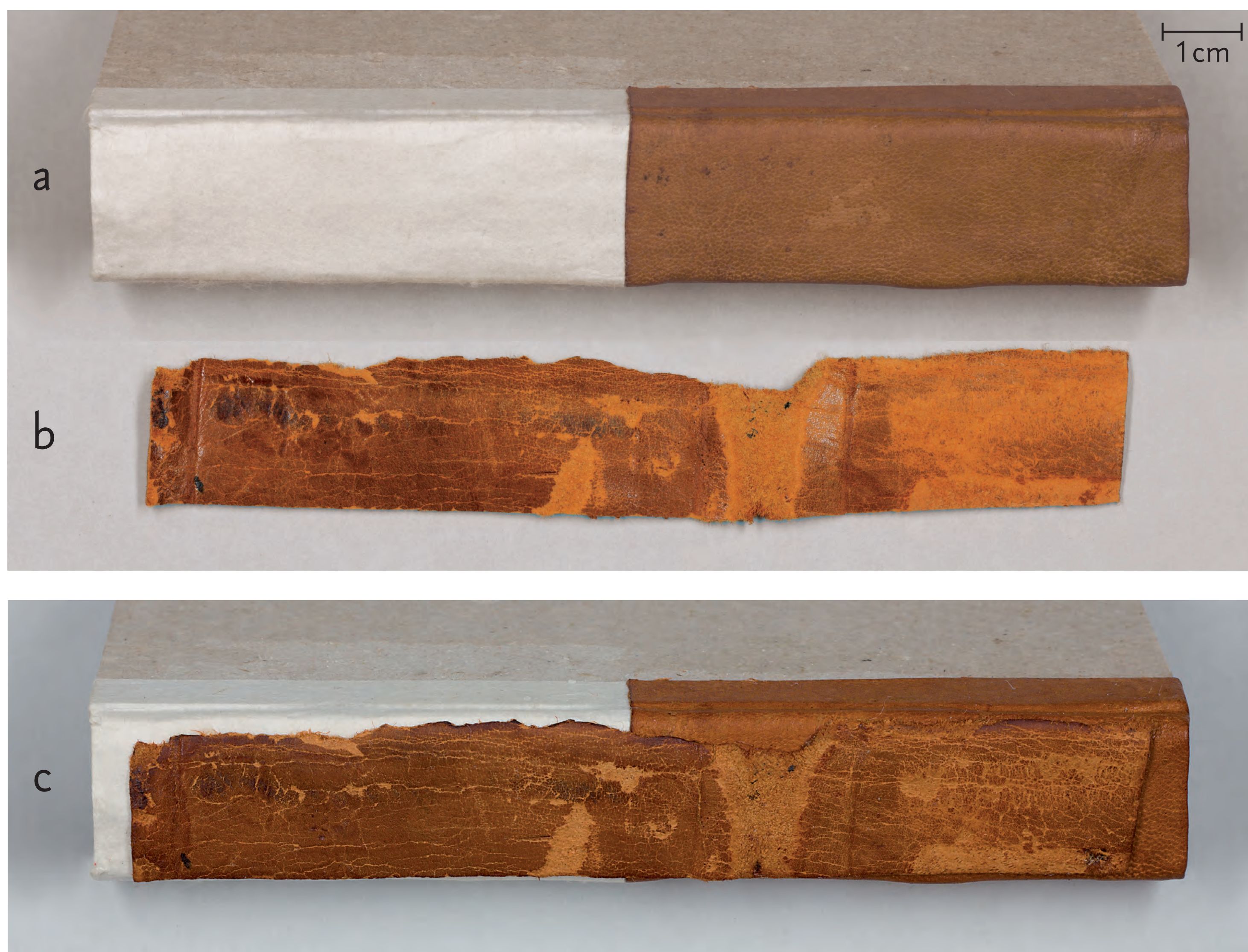
Abb. 1: Testbehandlung der Festigungsmaßnahme: (a) Für den Versuch wurde ein Buch hergestellt mit einer simulierten Rückenergänzung aus Japanpapier und Leder, die zwei Ergänzungsmaterialien darstellen. (b) Als historischen wieder aufzuklebenden Originalrücken fungiert ein Stück des Probenleders. (c) Der Nutzen wurde dreimal mit Medium für Konsolidierung, 10%ig in Butanol gefestigt. Die Abbildung zeigt den Buchrücken nach der Verklebung mit Weizenstärkekleister; das Leder ist an wenigen Stellen, vor allem an Randbereichen, verschwärzt und insgesamt leicht dunkler geworden.
